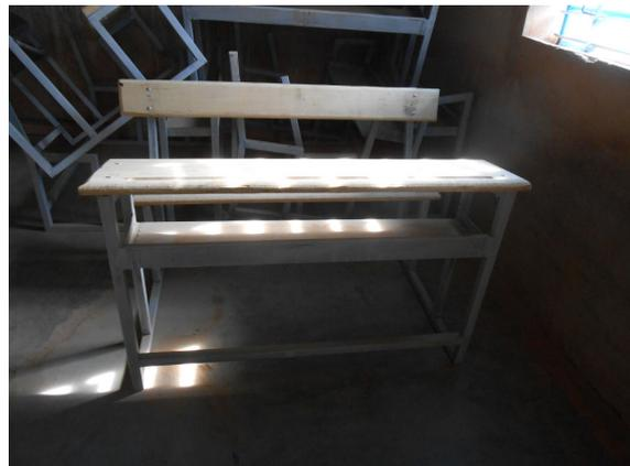
Des bancs d'école réalisés par un des formateurs. Les structures sont commandées à un soudeur et les planches de bois sont travaillées dans l'atelier.
